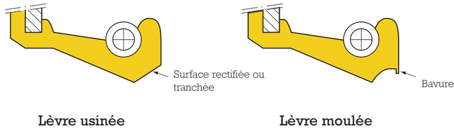
La lèvre moulée garantit un **meilleur respect géométrique de la lèvre du joint** en éliminant les dispersions d'usinage au niveau de :
